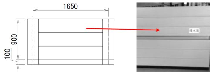
パネルの設置時には、パネルの「接水面」と記載している側を川側に向ける
