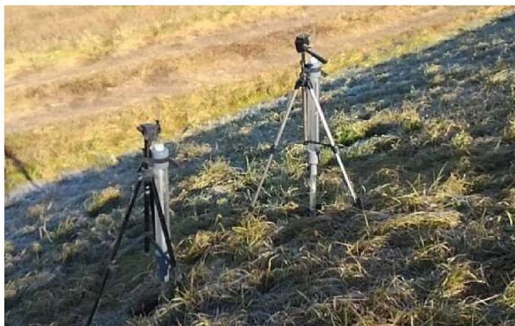
写真-1 現場透水試験状況(堤体のり面)
